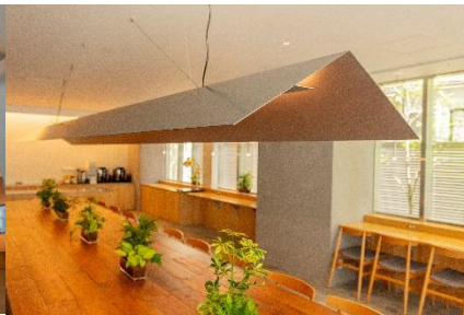
鉄板一枚板を折り曲げて作った 全長 6m の照明器具
